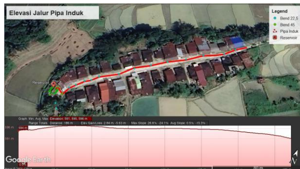
Gambar 7. Elevasi Pipa Transmisi Reservoir – Pipa Induk
